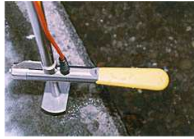
FIGURE 6.4 – Courantomètre électromagnétique (photo OTT)
