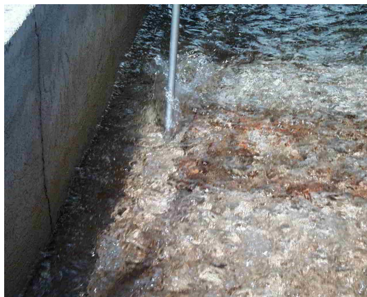
FIGURE 4.10 – Régime torrentiel : les ondes ne remontent pas le courant ; on peut en revanche avoir une estimation de la vitesse en mesurant la hauteur de la remontée du niveau d'eau sur l'obstacle : \delta h = U^2/2g
