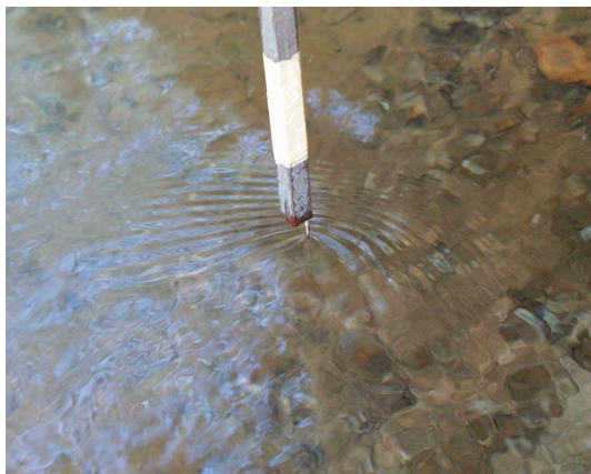
FIGURE 4.9 – Remontée des ondes en régime fluvial
