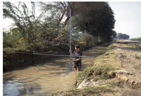
FIGURE 6.10 – Topométrie d'un canal d'irrigation, au niveau et à la mire
