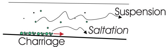
FIGURE 5.3 – Les différents modes de transport solide
