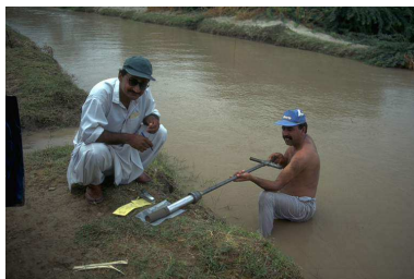
FIGURE 6.14 – Prélèvement d'une carotte de sédiments fins
