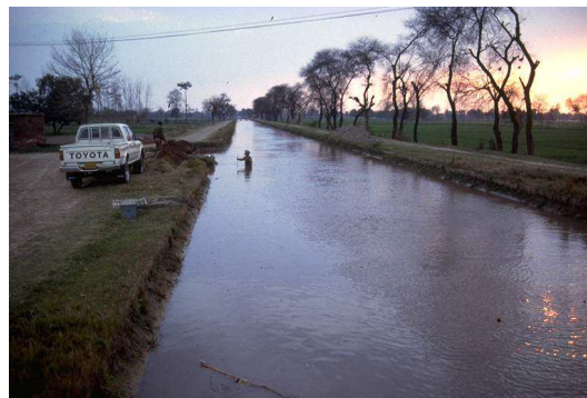
FIGURE 6.2 – Mesure du débit dans un canal d'irrigation. Ce type de chenal pose moins de problèmes quant au choix de la section. Toutefois, le profil de vitesse pourra être fortement perturbé par des objets tombés au fond du canal et on ne fera pas l'économie d'un grand nombre de verticales.
